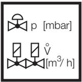
Nennleistung bzw. Drucksollwerte grundsätzlich am Gas-Druckregelgerät einstellen. Leistungsspezifische Drosselung über das Magnetventil.
