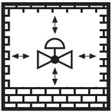
Direkter Kontakt zwischen dem Gas-Druckregelgerät und dem aushärtendem Mauerwerk, Betonwänden, Fußböden ist nicht zulässig.
