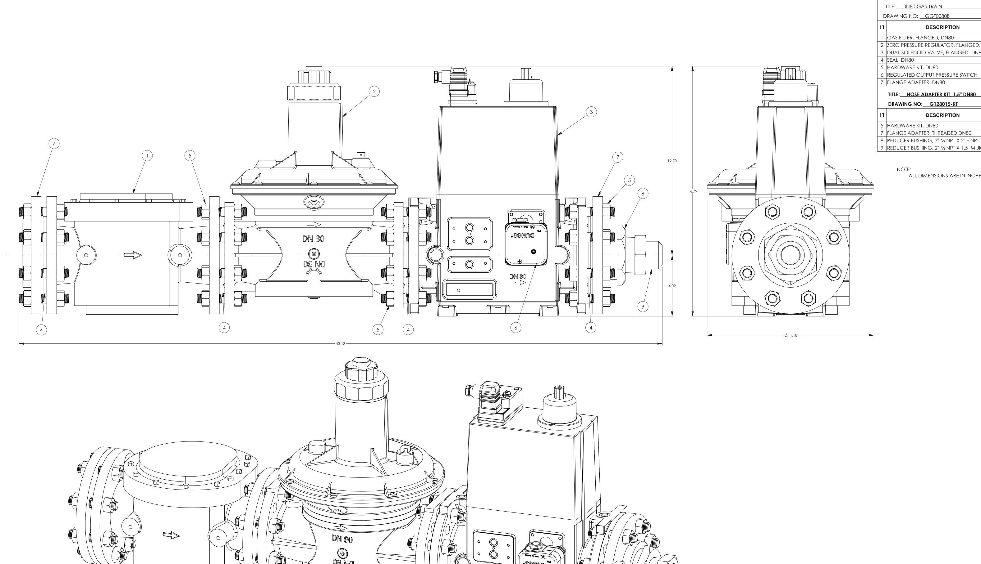
TITLE: <u>DN80 GAS TRAIN</u> DRAWING NO: GGT0080B DESCRIPTION DWG NO. | È 1 GAS FILTER, FLANGED, DN80 GFL003 2 ZERO PRESSURE REGULATOR, FLANGED, DN80 GGR007 3 DUAL SOLENOID VALVE, FLANGED, DN80 GSV006 4 SEAL, DN80 G12021 G11002 24
